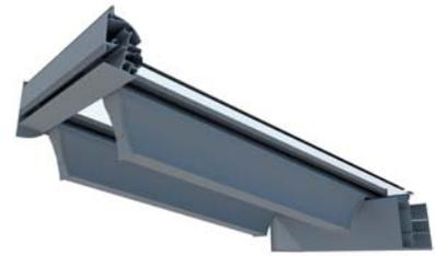
Meist sind die Profile der Dachträger so gestaltet, dass sie nach außen ragen. Wer eine besondere Konstruktion möchte, kann auf die „innen liegende Statik“ zurückgreifen. Hier ist das Dach außen besonders eben, was den Vorteil hat, dass sich weniger Schmutz und Laub zwischen den Profilen verfängen können. Auch die Reinigung kann hier leichter sein. Die Träger erstrecken sich in das Innere der Überdachung und können als interessantes Gestaltungselement eingesetzt werden.
